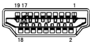
19 - полюсен сигнален кабел за цветен монитор
